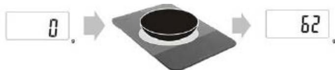
Весы оснащены функцией учета тары, которая позволяет точно взвесить объекты с ёмкостью. Ниже приводится последовательность действий:
