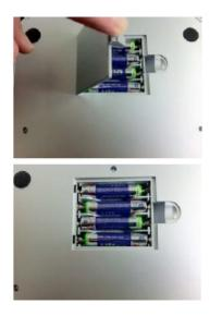
Вставьте 4 батарейки типа ААА, положение показано в батарейном отсеке. После этого поставьте крышку на место.
