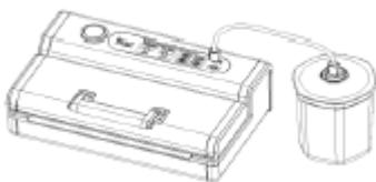
Закрепите один конец вакуум-шланга на патрубке прибора, а другой конец - на патрубке крышки сосуда.
