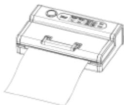
Закройте крышку, сильно нажав на ручку так, чтобы слышалось два щелчка.
