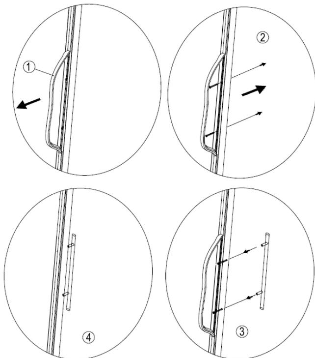
Прибор поставляется с одной металлической ручкой из нержавеющей стали. Для установки просто прикрутите ее к двери прилагаемыми винтами. Для этого сдвиньте резиновую прокладку с обратной стороны дверцы в сторону, чтобы открыть просверленные отверстия. Используйте прилагаемые винты, чтобы установить ручку на дверь.
