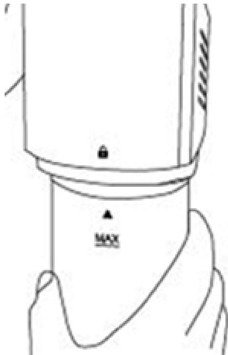
Закрутите кожух из нержавеющей стали по часовой стрелке, чтобы стрелка
