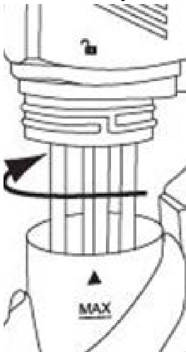
Наденьте кожух из нержавеющей стали на нагревательные стержни так, чтобы стрелка указывала на значок открытого замка
